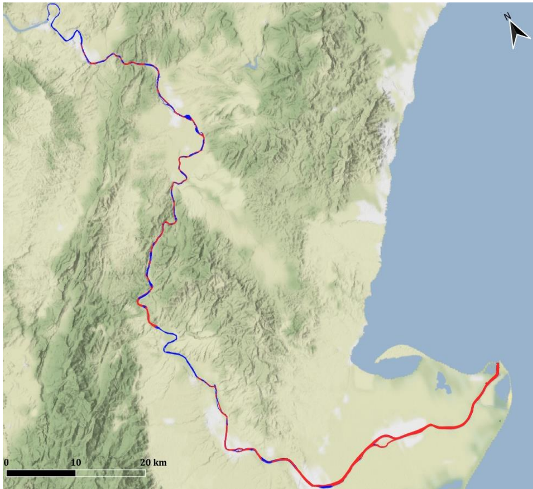
Figura 2. Ubicación de las áreas en las que se ha podido realizar batimetría multihaz (rojo) y los tramos en los que se han realizado los trabajos batimétricos con sonda monohaz (azul) para completar el tramo del Bajo Ebro.
