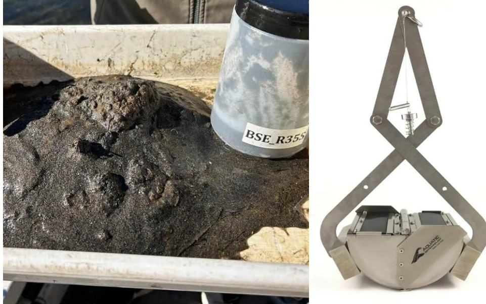
Figura 14. Muestreo para la extracción de sedimentos con un tamaño de partícula inferior a 2 mm. Draga tipo Ponar.
