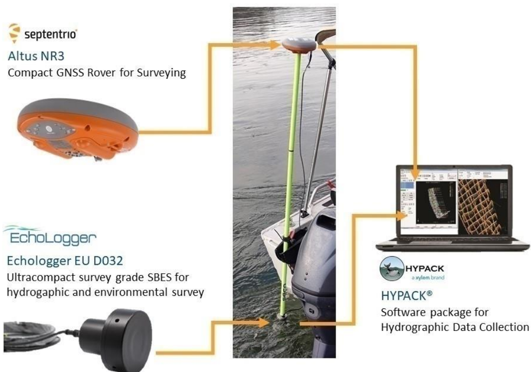
Figura 5. Representación de los elementos que configuran el sistema batimétrico utilizado.
