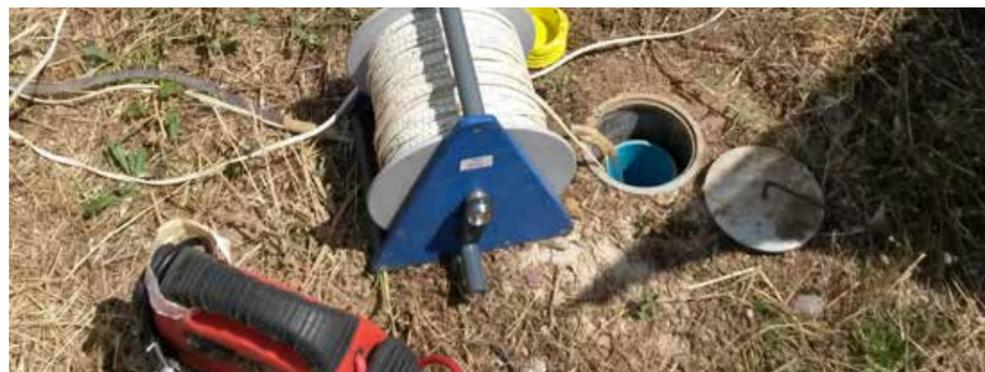
Control piezométrico de agua subterránea
